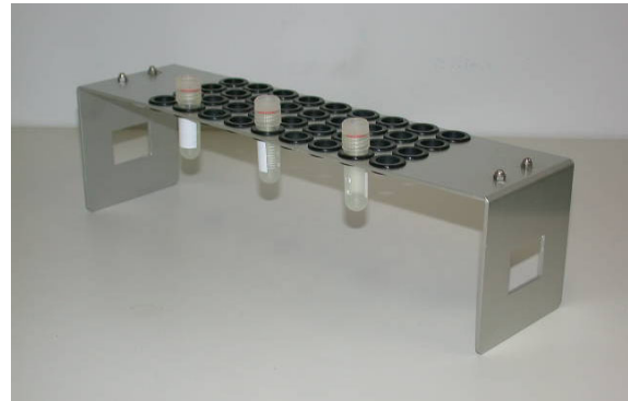
図 2 試料部分が覆われないもの 1.5 (2) mL チューブ用ラック TR4002 (マイクロ チューブミキサー MT-400 付属品、トミー精工)
